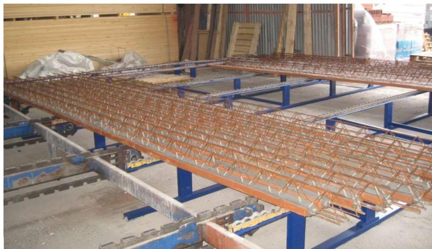
Durante la sosta nella zona di prestoccaggio vengono effettuati tutti i controlli di produzione previsti. Trascorso il tempo minimo di 24 ore si procede alla realizzazione manuale delle cataste che vengono trasportate tramite carrello elevatore nella zona di stoccaggio, dove la successiva sosta garantisce la maturazione minima del calcestruzzo necessaria per il trasporto in cantiere del prodotto stesso (vedi 1.3 CARICO E TRASPORTO DEL PRODOTTO IN CANTIERE).
